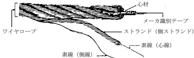
図-2 ワイヤロープの基本構成図
